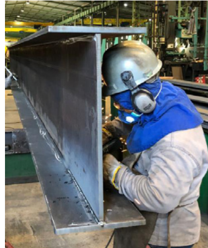
Figura 79 - Perfil I Soldado produzido com aço da ArcelorMittal Tubarão. Fonte: ArcelorMittal.
