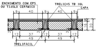
TRELIÇA: altura H16 Modelo ArcelorMittal **TB 16R TR16746**  CONCRETO: Resistência de 20 MPa
