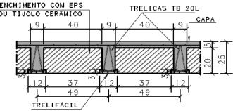
TRELIÇA: altura H20 Modelo ArcelorMittal **TB 20R TR20756**  CONCRETO: Resistência de 20 MPa
