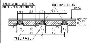
TRELIÇA: altura H12 Modelo ArcelorMittal **TB 12M TR12645**  CONCRETO: Resistência de 20 MPa
