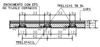
TRELIÇA: altura H8 Modelo ArcelorMittal **TB 8M TR8645**  CONCRETO: Resistência de 20 MPa
