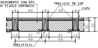
TRELIÇA: altura H25 Modelo ArcelorMittal **TB 25M TR25856**  CONCRETO: Resistência de 20 MPa
