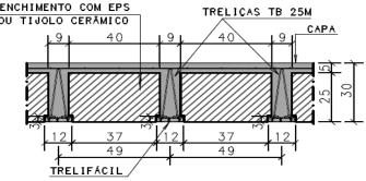
TRELIÇA: altura H25 Modelo ArcelorMittal **TB 25R TR25858**  CONCRETO: Resistência de 20 MPa
