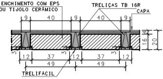
TRELIÇA: altura H20 Modelo ArcelorMittal **TB 20L TR20745**  CONCRETO: Resistência de 20 MPa
