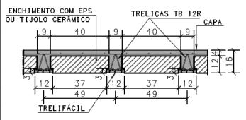
TRELIÇA: altura H16 Modelo ArcelorMittal **TB 16L TR16745**  CONCRETO: Resistência de 20 MPa
