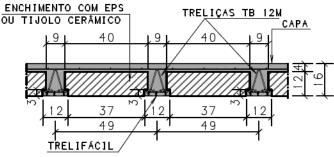
TRELIÇA: altura H12 Modelo ArcelorMittal **TB 12R TR12646**  CONCRETO: Resistência de 20 MPa
