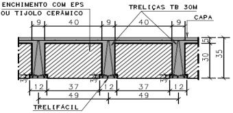
TRELIÇA: altura H30 Modelo ArcelorMittal **TB 30R TR30858**  CONCRETO: Resistência de 20 MPa
