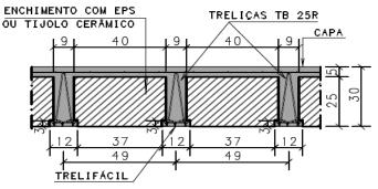
TRELIÇA: altura H30 Modelo ArcelorMittal **TB 30M TR30856**  CONCRETO: Resistência de 20 MPa
