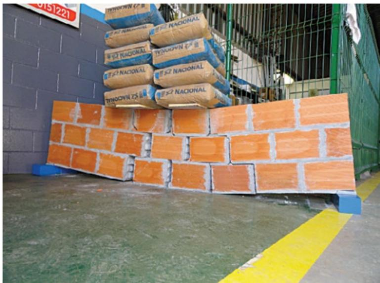
Neste teste, a alvenaria sem reforço se rompeu com 450 kg (9 sacos de cimento).
