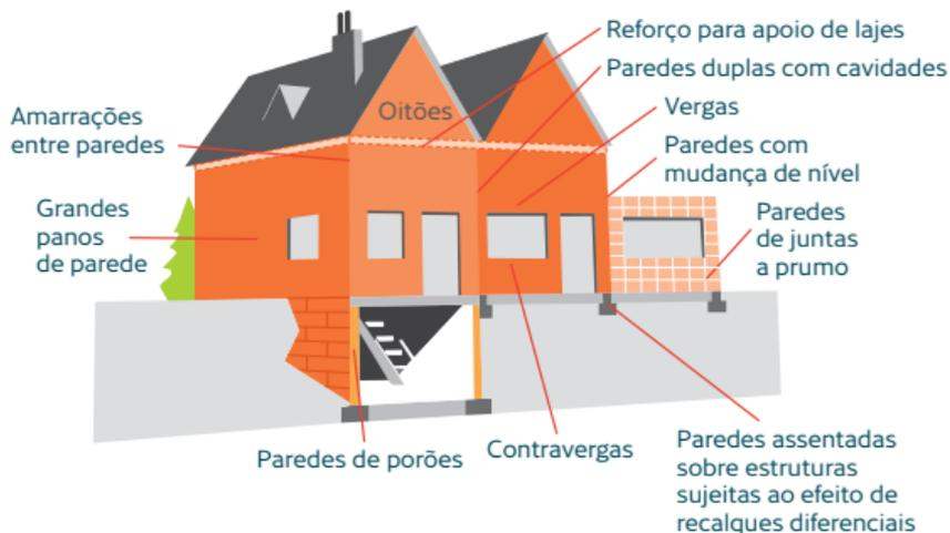
As paredes são elementos rígidos que apresentam baixa capacidade de deformação. Por exemplo, quando vigas ou lajes apresentam deformações acentuadas, elas introduzem elevados níveis de tensões nas paredes, possibilitando o surgimento de fissuras. Paredes reforçadas com treliças Murfor® apresentam um melhor desempenho estrutural, minimizando a ocorrência ou intensidade dessas fissuras. As mais comuns são aquelas a 45°, que surgem nas quinas dos vãos de janelas e portas.
