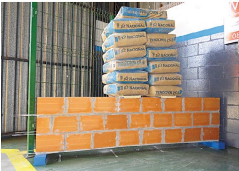
Já a alvenaria reforçada com Murfor® suportou a carga de 650 kg (13 sacos de cimento) sem apresentar fissuras.
