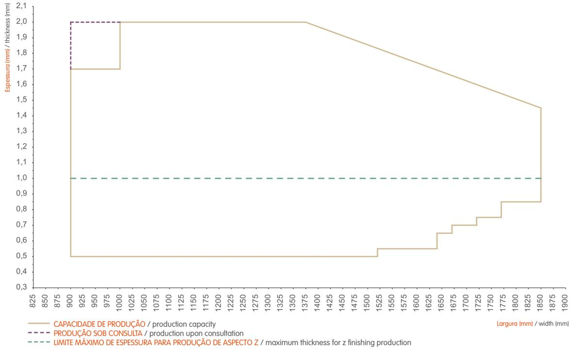
**BOBINA GALVANIZADA (GI/GA) - QUALIDADES INTERNAS AM02 A AM06 - GALVANIZAÇÃO 1**
