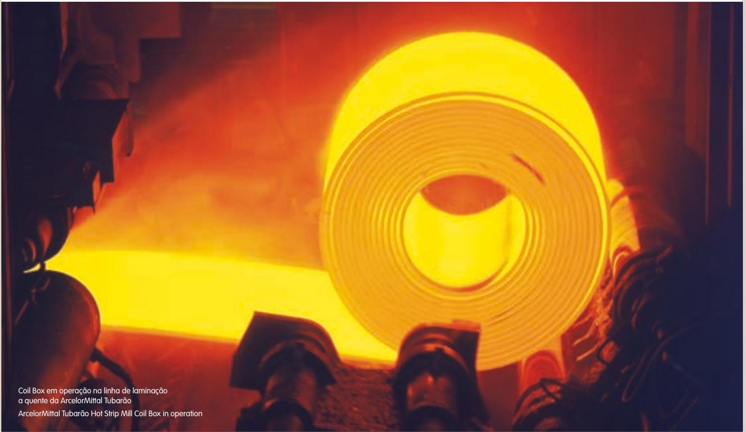
Coil Box em operação na linha de laminação a quente da ArcelorMittal Tubarão
