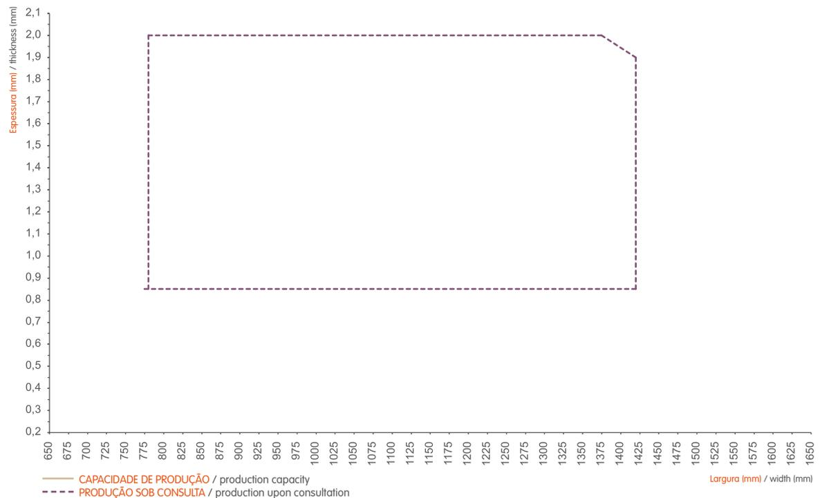
**BOBINA GALVANIZADA (GI/GA) - QUALIDADES INTERNAS AM01 E AM HSLA240 - GALVANIZAÇÃO 1**
