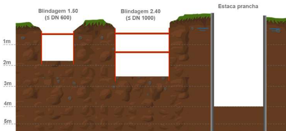
Blindagem de vala 1,50m (1)
