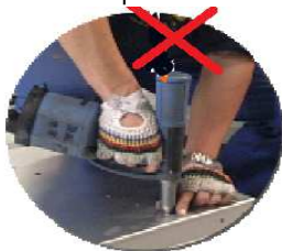
Uso de berbequim, porém com luvas impróprias causando impressões de mãos na chapa
