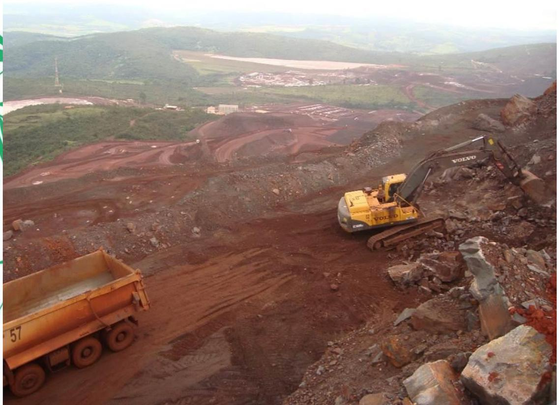
Serviço de escavação de itabiritos utilizando-se conjuntos de escavadeiras hidráulicas e caminhões 6 x 4 na área licenciada do Processo DNPM nº 812.593/73.
