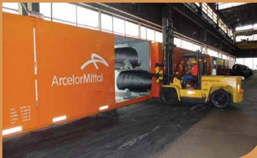
Vagão especial de fio-máquina desenvolvido em Monlevade: garantia de integridade da carga
