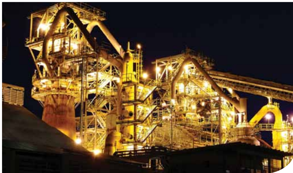
Altos-fornos a carvão vegetal em Juiz de Fora: menos emissões e mais eficiência energética
