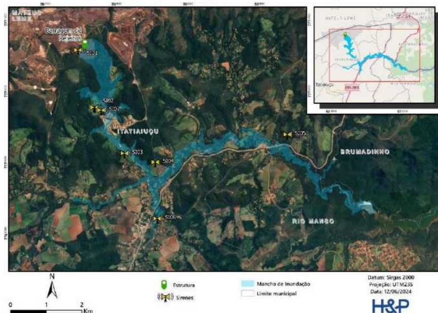
Figura 3. Localização das sirenes em relação à mancha de inundação da estrutura
