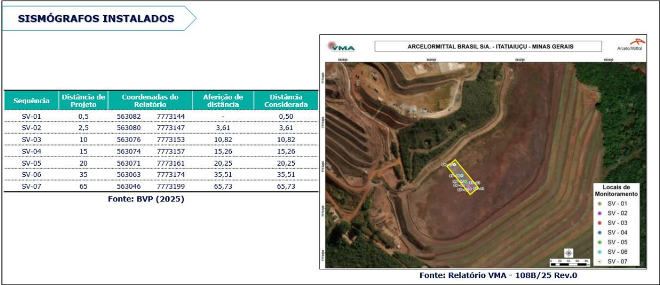
Figura 19: Detalhes da pista teste, indicando a localização dos sismógrafos instalados. Fonte da Imagem: BVP
