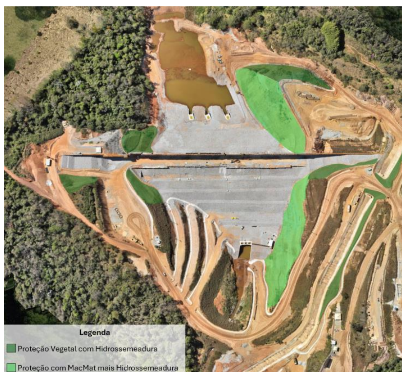
Figura 17: Layout de implantação das proteções de talude.
