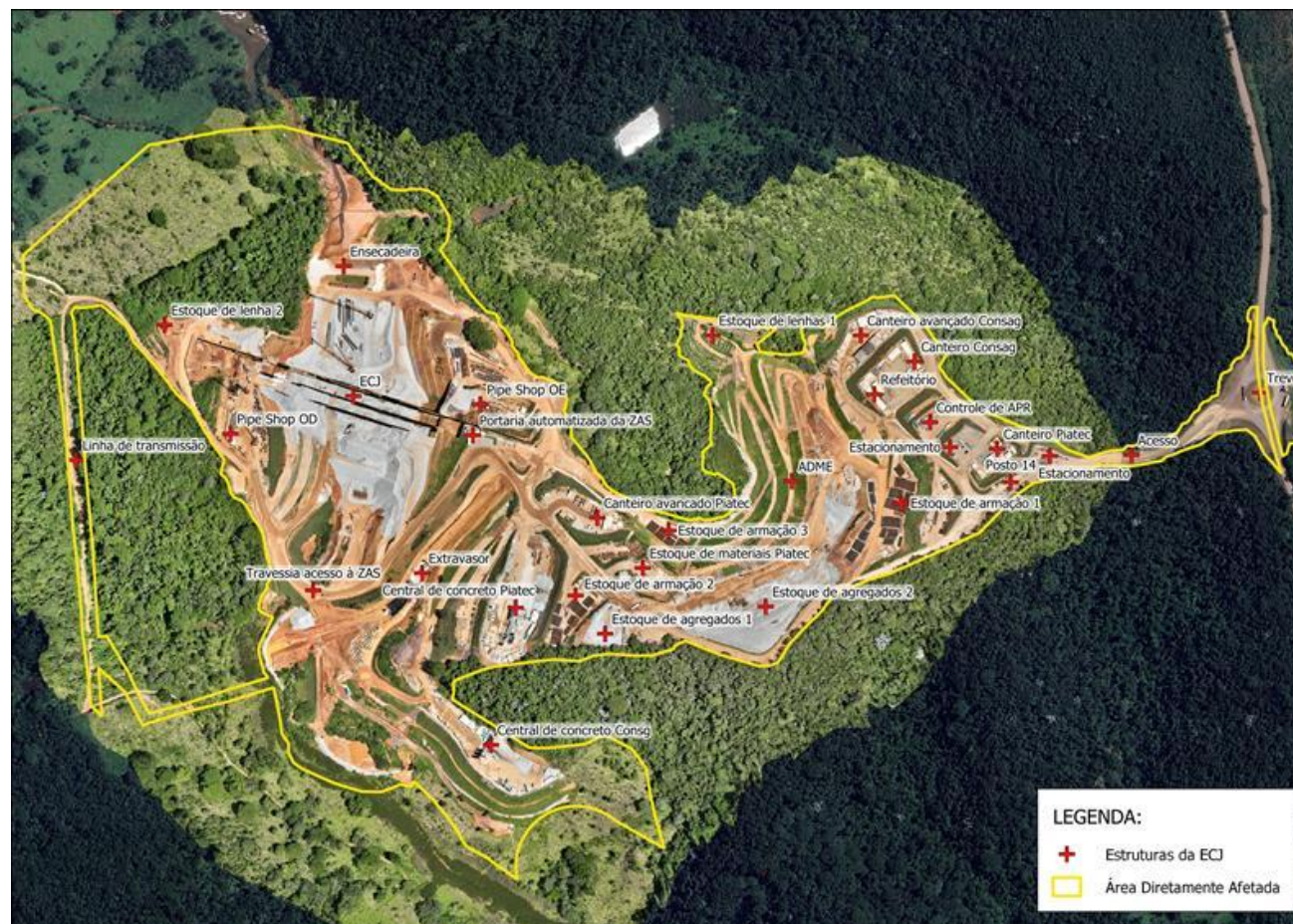
Figura 12: Layout das áreas da Estrutura de Contenção a Jusante (dezembro/2024)
