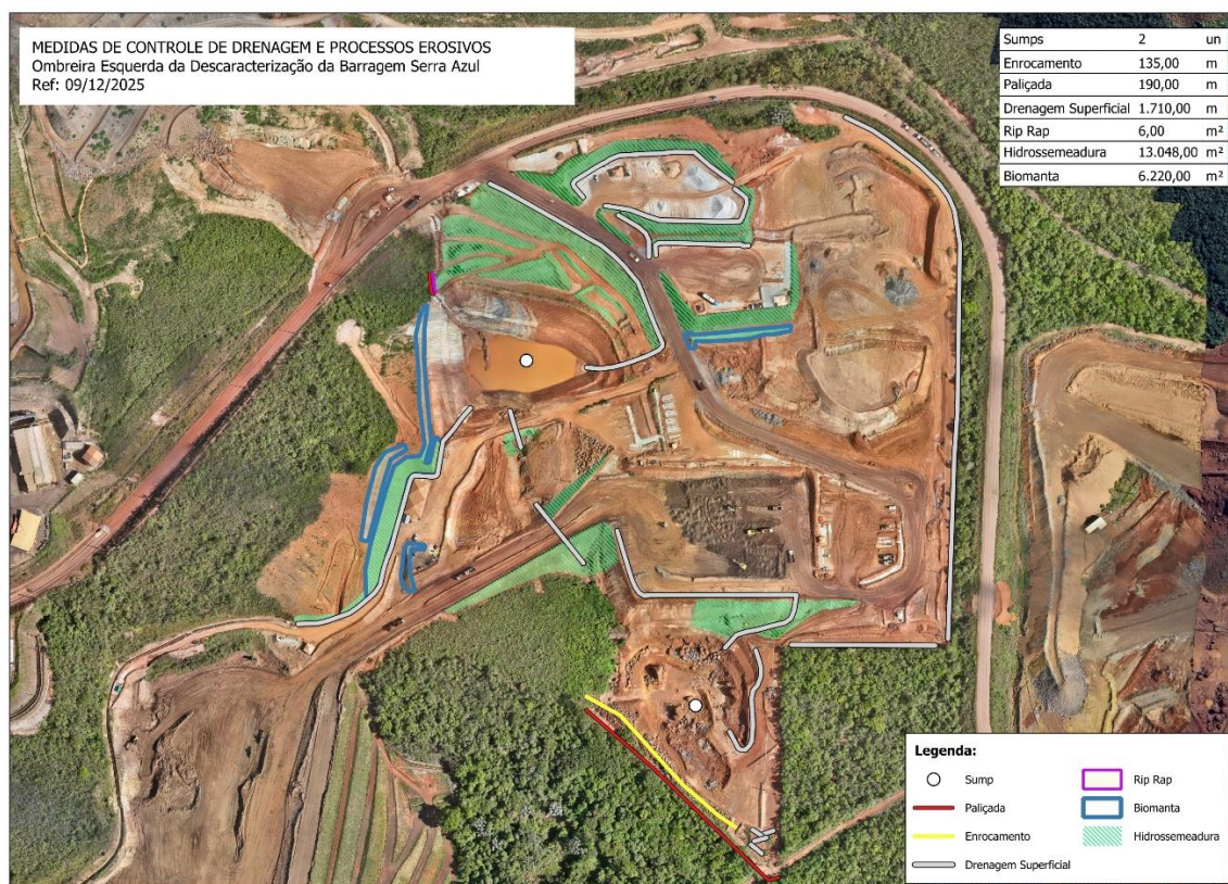
Figura 46: Medidas de controle de drenagem e processos erosivos associadas ao Plano de Chuva 2025/2026 na área da Descaracterização (em andamento)
