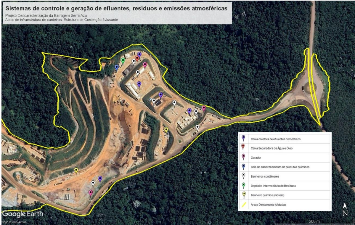
Figura 41: Sistemas de controle e geração de efluentes, resíduos e emissões atmosféricas no Projeto de Descaracterização na área da ECJ
