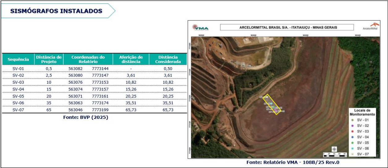
Figura 26: Detalhes da pista teste, indicando a localização dos sismógrafos instalados. Fonte da Imagem: BVP
