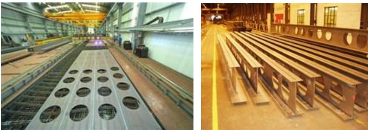
**Figura 9 – Vigas celulares soldadas com furos cortados diretamente na chapa da alma.**
