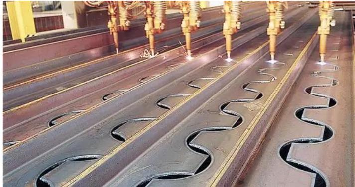
**Figura 3 – Corte na alma para produção das metades de uma viga celular.**
