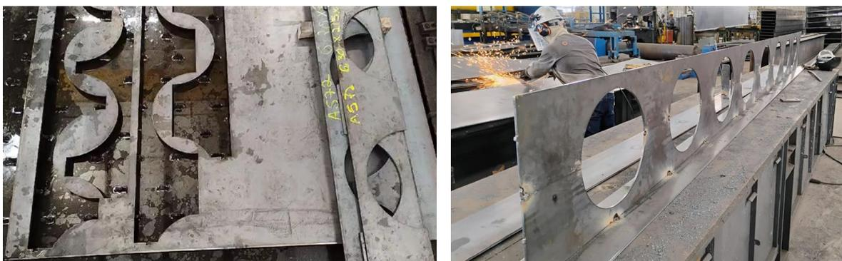
**Figura 8 – Corte e montagem de uma viga celular soldada.**
