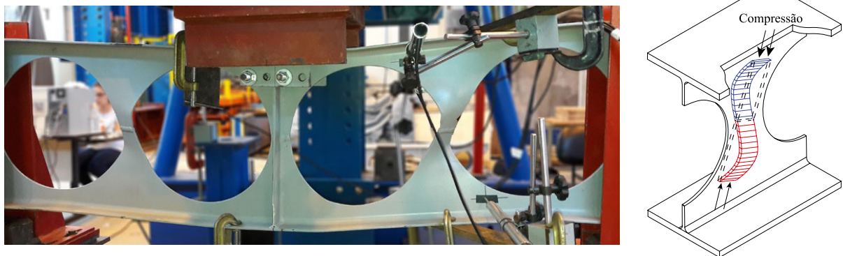
Figura 120 – Aspecto do modo de falha por flambagem do montante de alma por cisalhamento. (fonte: Grilo, 2018)
