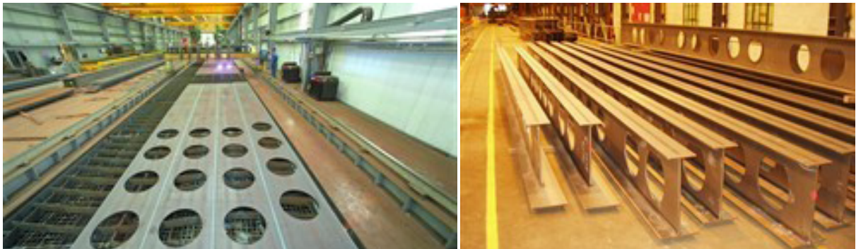
Figura 7 – Vigas celulares soldadas com furos cortados diretamente na chapa da alma. (fonte: http://www.fabsec.co.uk – acessado em 22/02/2012).
