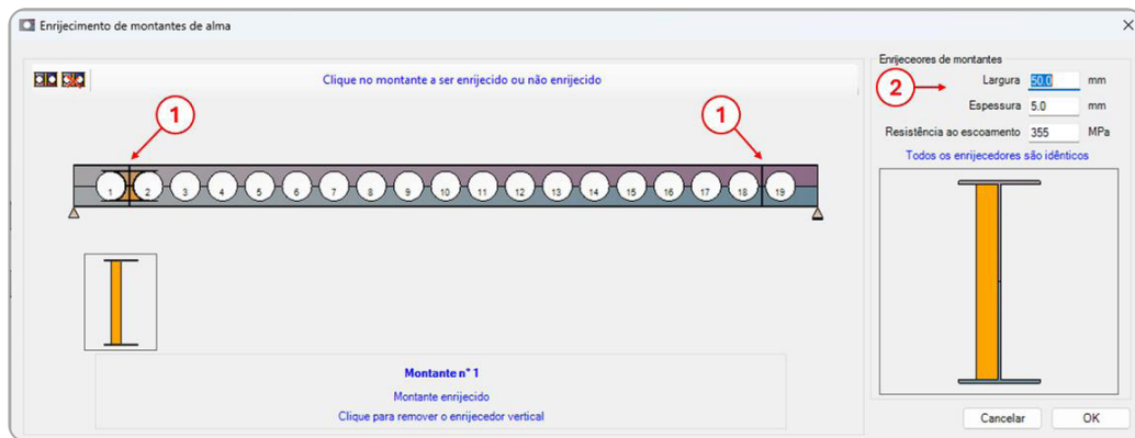
Figura 79 - Configuração do enrijecimento de montantes de alma.
