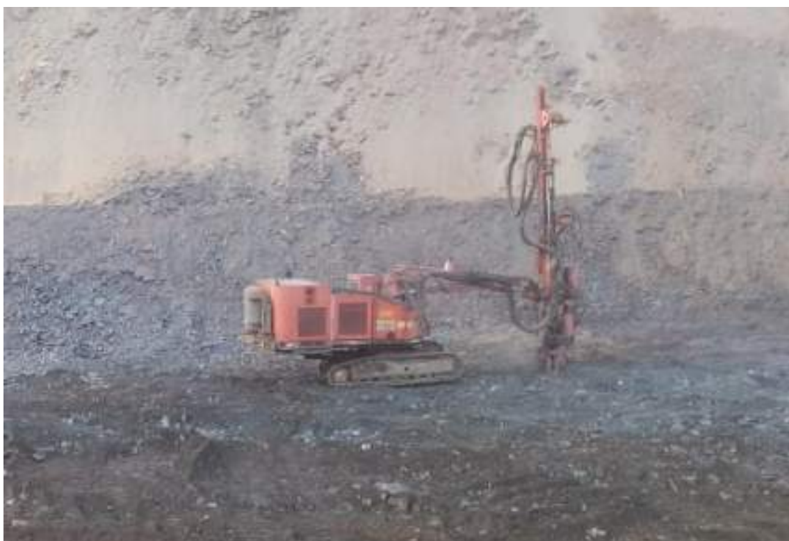
Figura 9 - Perfuratriz hidráulica Sandvik
