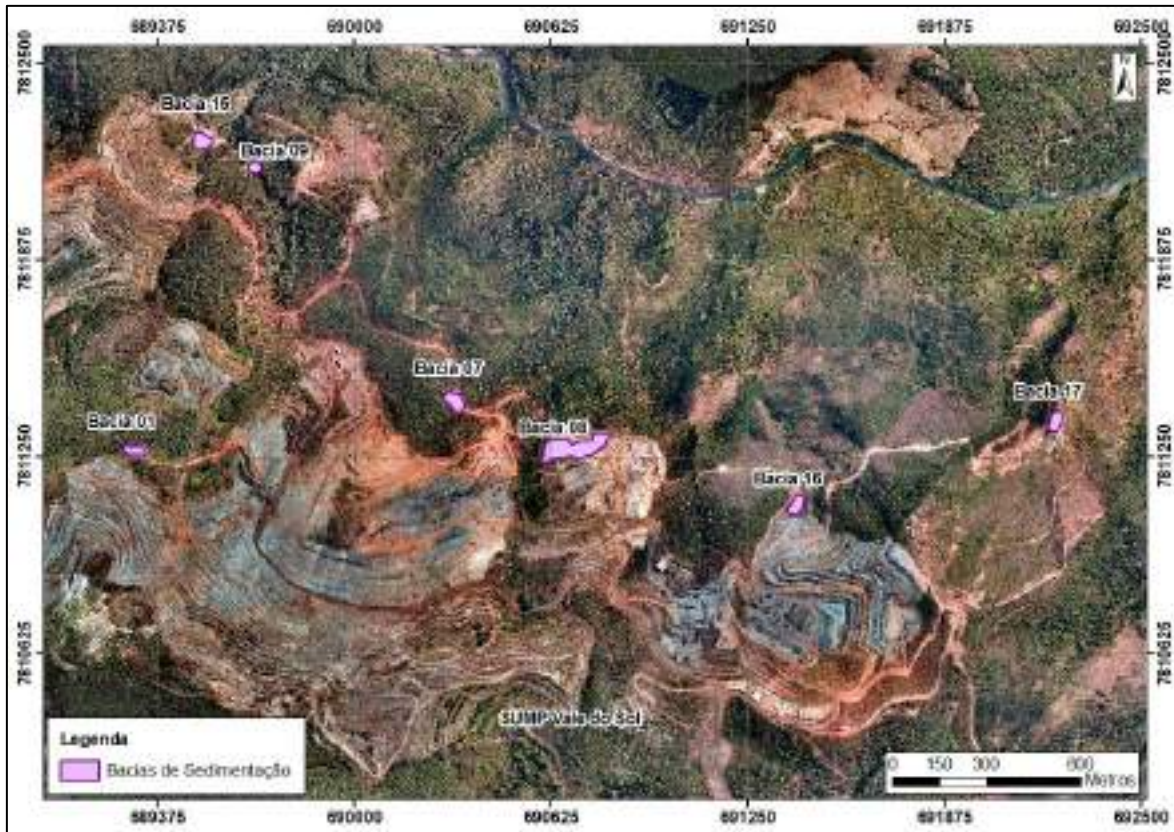
Figura 7.18 – Bacias de Contenção de Sedimentos
